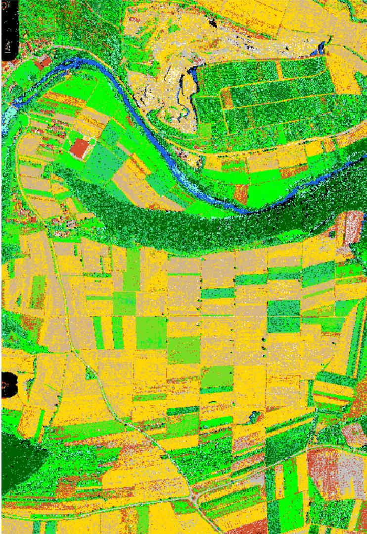
Abb. 8 Klassifizierung RGI + NDVI, ungefiltert
